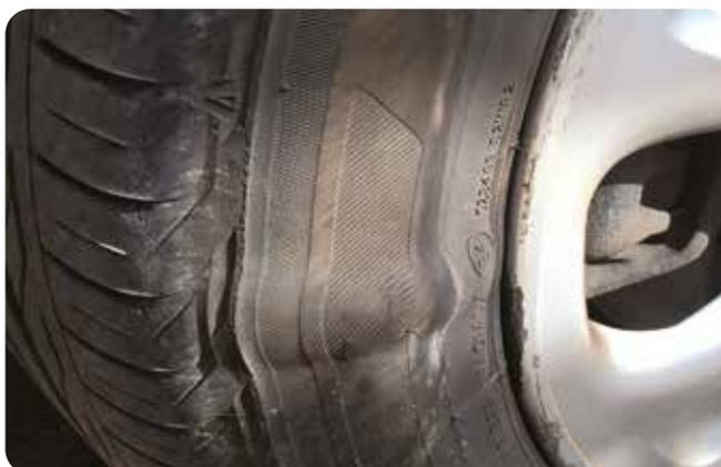
Foto de ejemplo de daños por impacto en el neumático:
